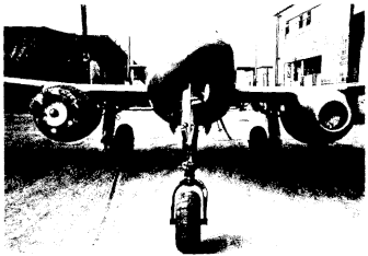
Einbau der He 58 A-Triebwerke in die He 280 V3
